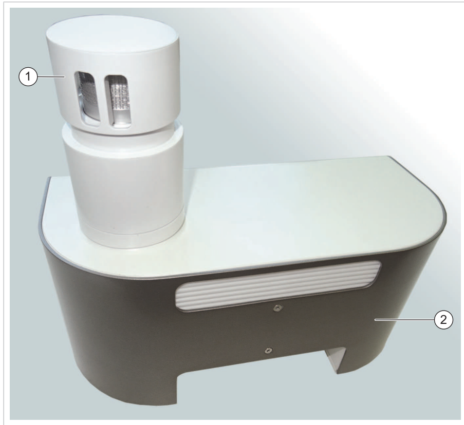
Gerät mit Trocknungsstrecke, Probenahmekopf und montierter Rückwand
