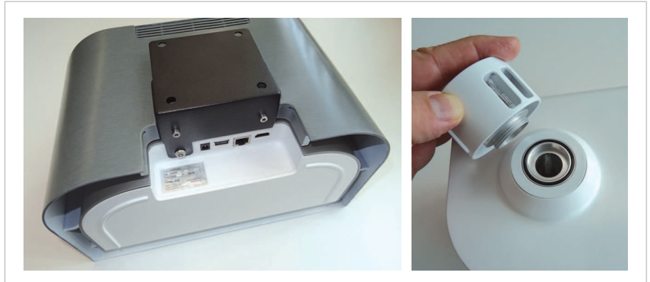
Fidas Smart 100 – Demontage des Wandhalters und des Probenahmekopfes
