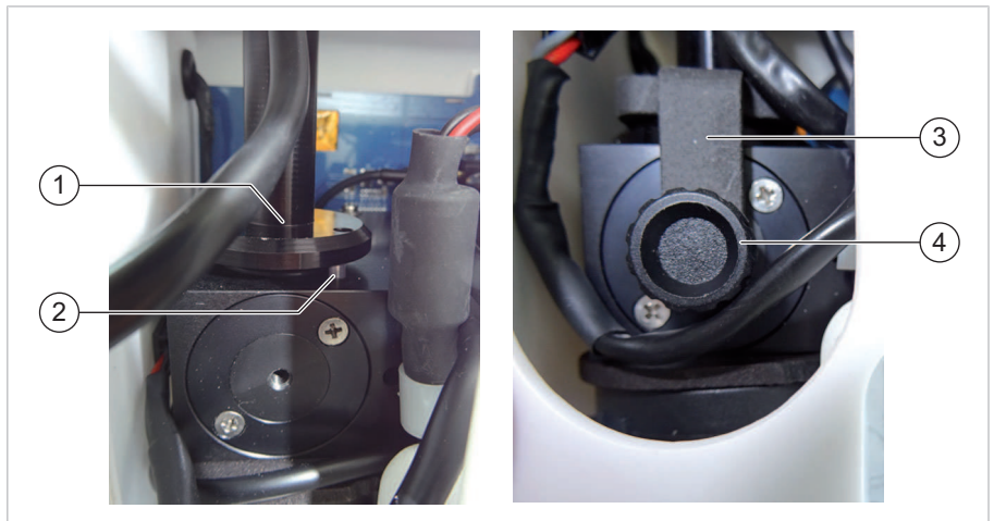
Einsetzen und Fixieren des Aerosoleinlassrohrs
