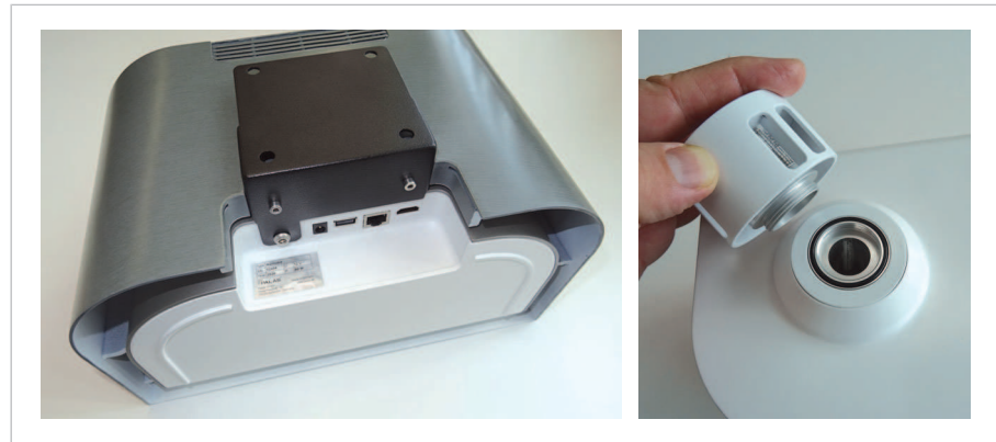
Fidas Smart 100 – Demontage des Wandhalters und des Probenahmekopfes
