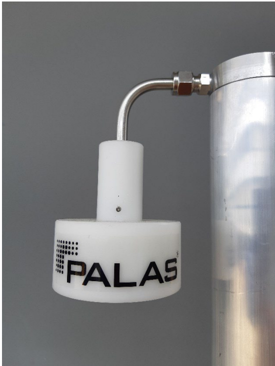
Abbildung 7: Wettersensor am Probenahmerohr
