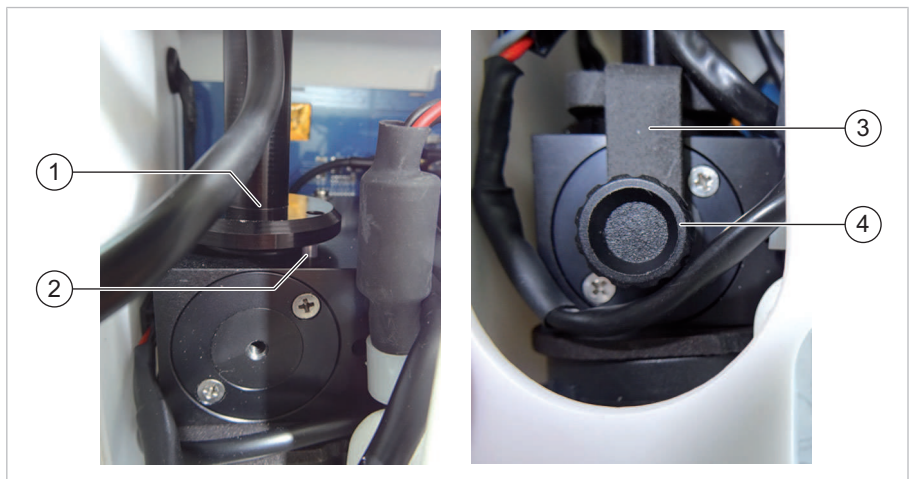
Einsetzen und Fixieren des Aerosoleinlassrohrs
