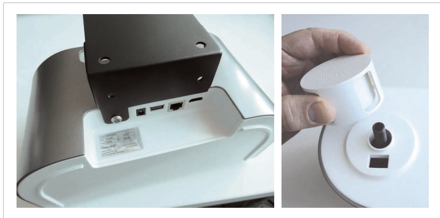
Fidas Smart Steuereinheit – Demontage des Wandhalters und des Probenahmekopfes
