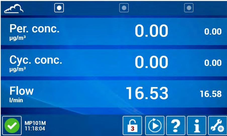
Die Startseite zeigt maximal drei Messkanäle auf einmal an.
