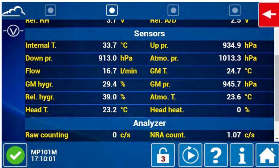
Auf der dritten Seite befinden sich der Status der Bedienelemente, die Liste der Komponenten und deren Status, sofern sie beim Start des Analysators erkannt werden. Die Tasten ON / OFF werden verwendet, um zu überprüfen, ob die entsprechenden Elemente korrekt funktionieren. Verlässt der Benutzer den Bildschirm, kehren die Elemente zu ihrem Standardstatus zurück.
