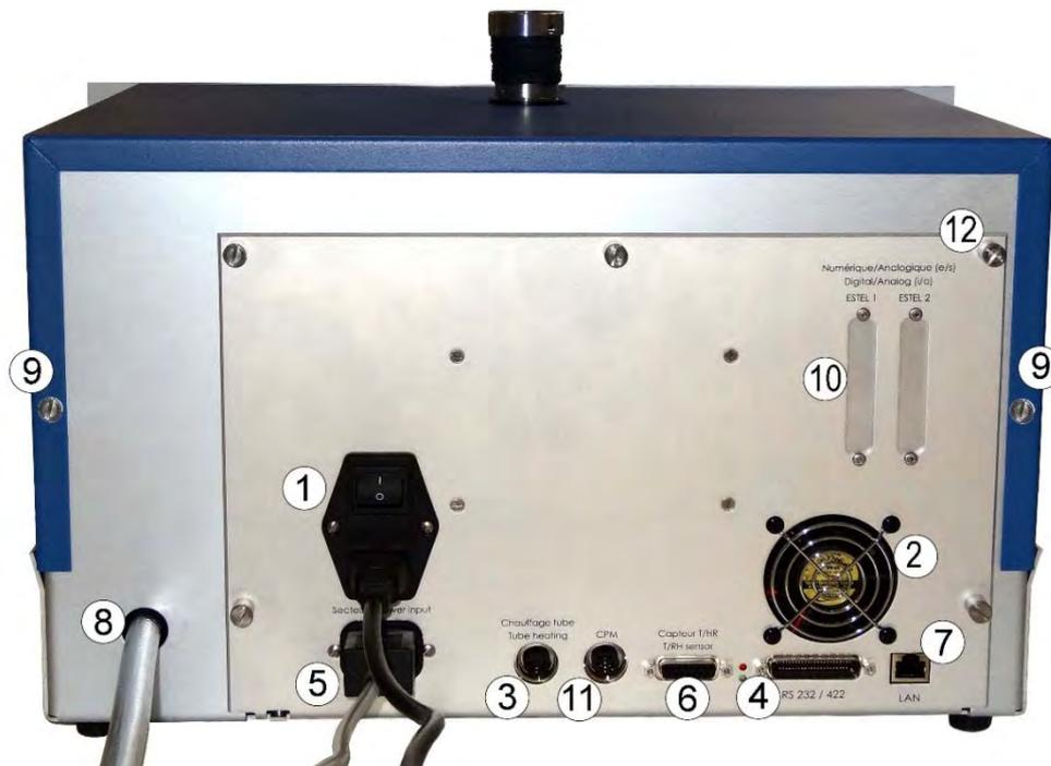
(1) Hauptsicherung F1 und Netzteil, (2) Ventilator, (3) TUCHEL-Anschluss für die Heizung des Kopfes, (4) RS232/RS422-Anschluss, (5) Versorgung externe Pumpe, (6) Kopsensor, (7) TCP/IP-Anschluss, (8) Pumpenausgang, (9) Befestigungsschraube der Abdeckung, (10) optionale ESTEL-Karte, (11) Anschlussbuchse für CPM-Option, (12) Befestigungsschraube des Auszugs auf der Rückseite.
