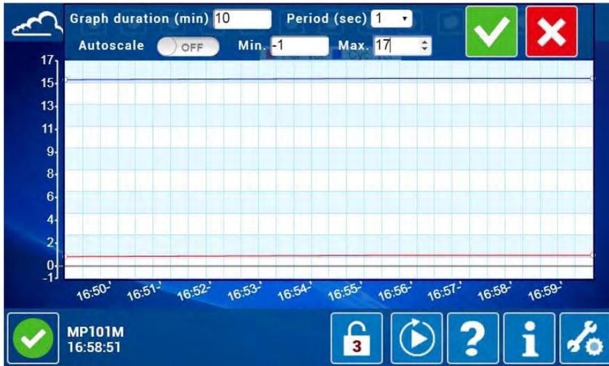
Zur Aktivierung der Zoom-Funktion wählt der Benutzer den Zoombereich durch Berühren / Anklicken des Bereichs oder durch Verwendung des Mauszeigers aus: Dadurch wird der gewählte Bereich grau. Der Benutzer validiert die Auswahl durch Berühren / Anklicken von
