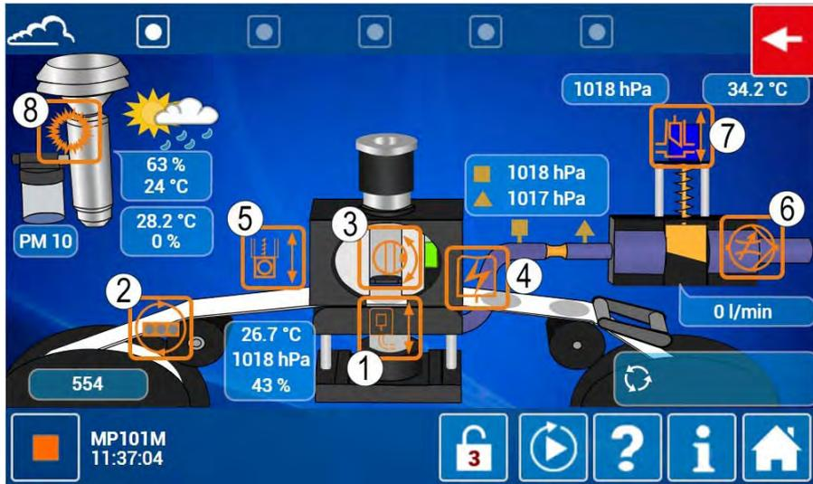
**Definition der Kontrolltasten:** (1) Motor Teller, (2) Motor Papiervorschub, (3) Motor Quellenträger, (4) Test Hochspannungsversorgung, (5) Motor automatisches Normalmaß (optionaler Test bei aktiviertem Endmaß), (6) Pumpe, (7) Ventilmotor, (8) Heizung RST-Leitung.
