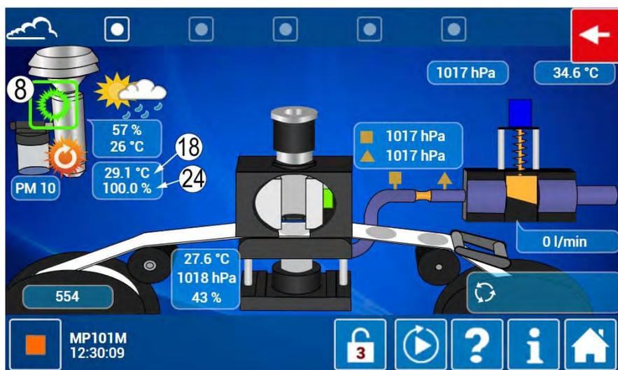
(24) Prozentsatz der Heizleistung der Probenahmeleitung ändert sich von 0 auf 100 %.
