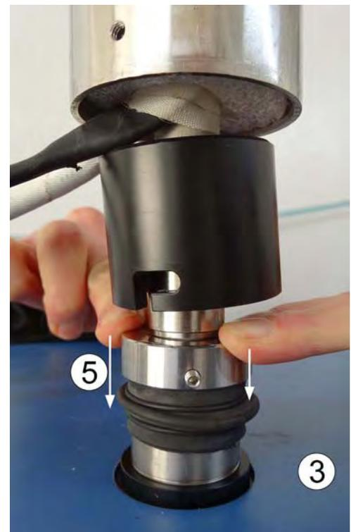
C) Sichern Sie anschließend die Probenahmeleitung mit für diesen Zweck vorgesehenen Flanschen (Außenflansch + Innenflansch).
