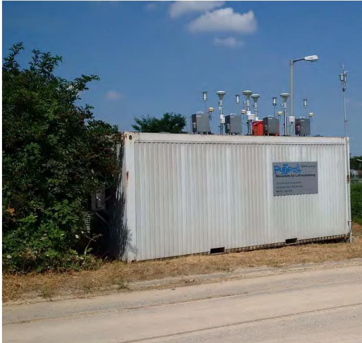
Abbildung 5: Messsysteme MP101M auf Messstation (Schüttgutumschlag)
