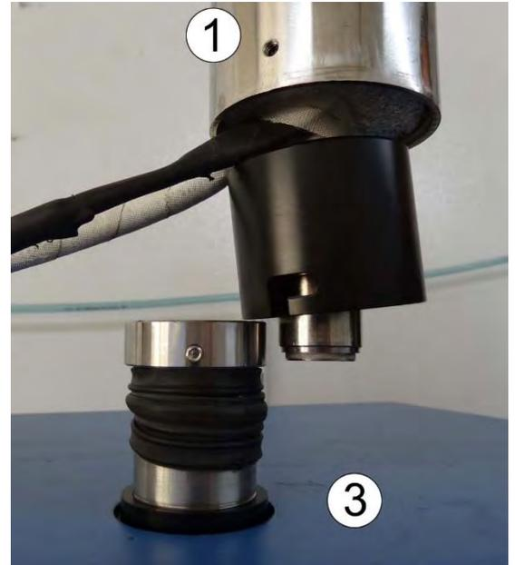
B) Die Probenahmeleitung darf nicht den zusammenschiebbaren, auf den Probeneingang aufgeschraubten Stutzen (4) des MP101M zerquetschen. Die Flexibilität (5) des zusammenschiebbaren Stutzens muss aufrechterhalten werden, um den MP101M (3) aus der Leitung herausnehmen zu können, ohne zuvor die Leitung zu deinstallieren.
