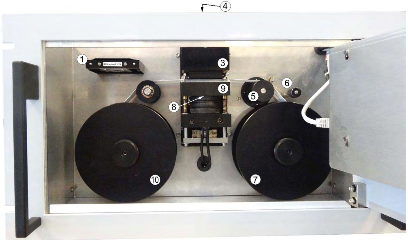
(1) Endmaß, (3) Quellenträger, (4) zusammenschiebbarer Stutzen am Probegaseingang, (5) Capstan, (6) Andruckrolle, (7) Aufwickelrolle, (8) Aufnahme des Geiger-Müller-Detektors, (9) Andruckvorrichtung, (10) Abwickelrolle.
