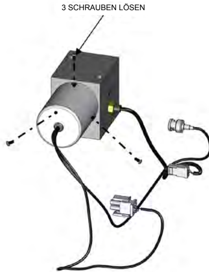
Abbildung 7–38. Abnehmen der PMT-Abdeckung
