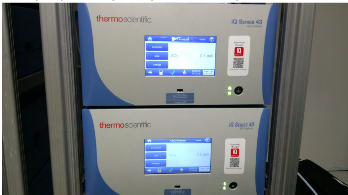
Abbildung 6: 43iQ Testgeräte mit Messwertanzeige
