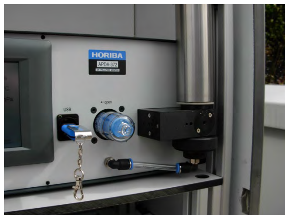
Abbildung 57: APDA-372 Steuereinheit, Aerosolsensor mit IADS
