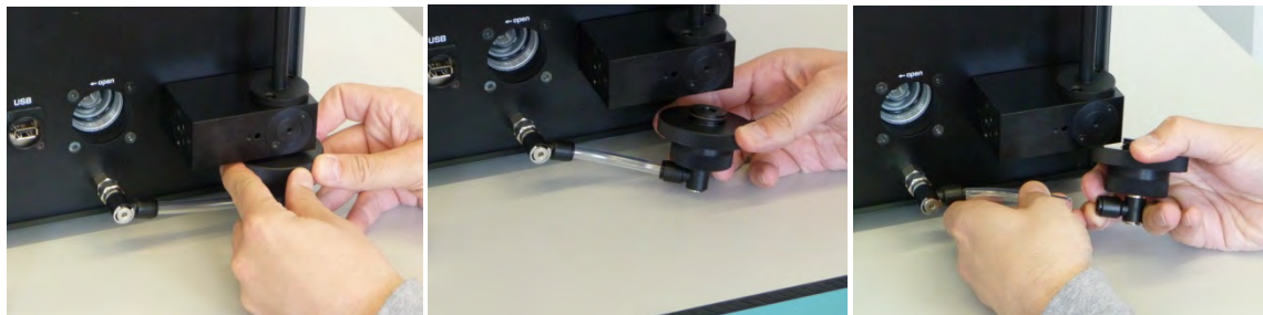
Abbildung 35: (A-C) Entfernen des Filters
