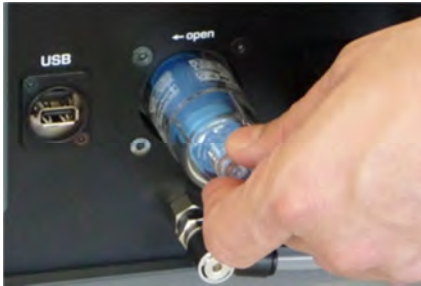
Abbildung 40: Entfernen der Schutzkappe
