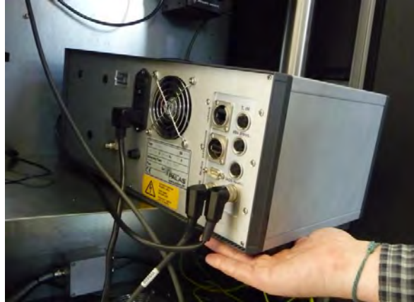
Abbildung 9: Verbinden der Wetterstation, IADS mit den Anschlüssen auf der Rückseite
