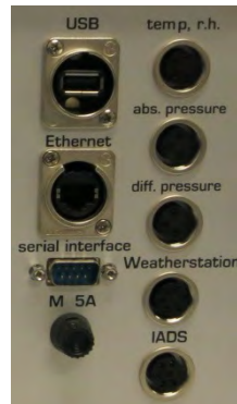
Abbildung 4: Anschlussmöglichkeiten auf der Rückseite des APDA-372 Steuereinheit
