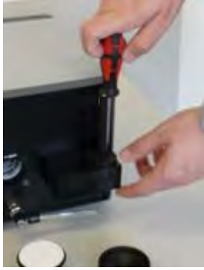
Abbildung 36: Lösen der M3 Kreuzschlitzschrauben
