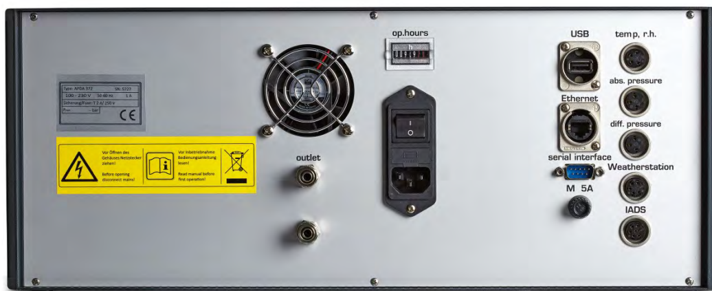
Abbildung 3: Rückseite des APDA-372 Steuereinheit
