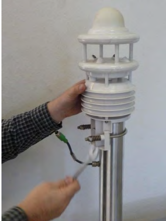
Abbildung 7: Anbringen der Wetterstation am Rohr
