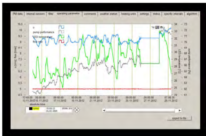
Abbildung 13: Reiter "operating parameter" – zeigt die Partikelgeschwindigkeit, Pumpenleistung, LED-Temperatur und den Durchfluss an.
