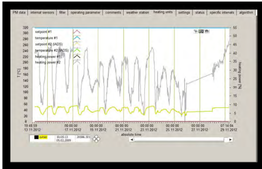
Abbildung 17: Überblick über die Heizelemente im ADPA-372 200/200 S, 300/300 S
