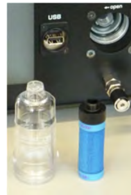
Abbildung 43: Ausgebauter Filter und Schutzkappe
