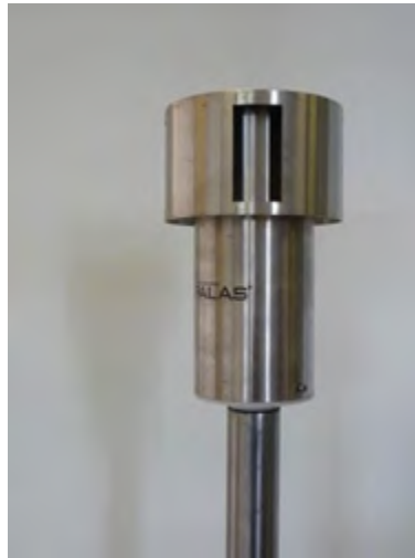
Abbildung 10: Sigma2-Probenahmekopf für Fidas ® 200 S bzw. Fidas ® 200
