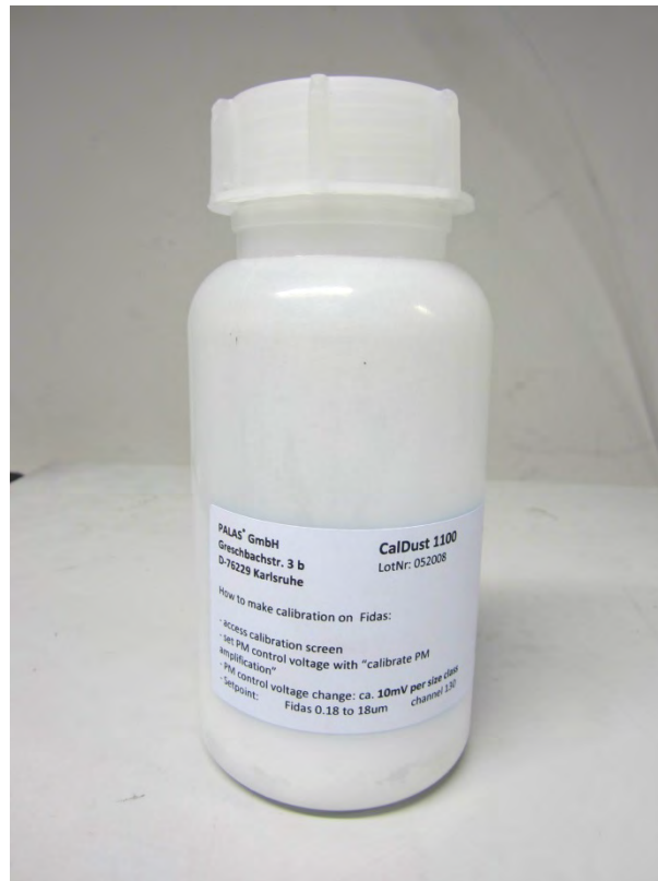
Abbildung 19: CalDust 1100 zur Verifizierung / Kalibrierung der Empfindlichkeit
