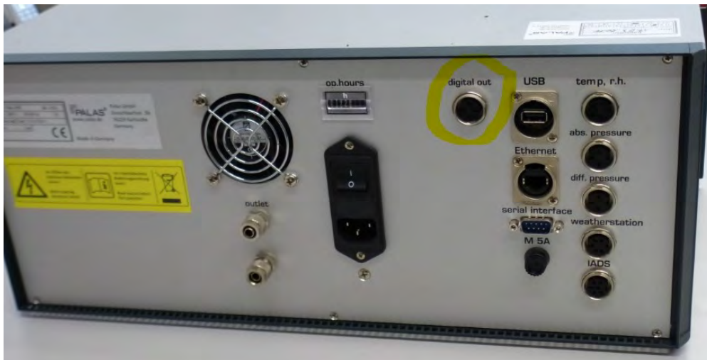
Abbildung 129: Geräterückseite mit zusätzlicher Buchse (gelb markiert)
