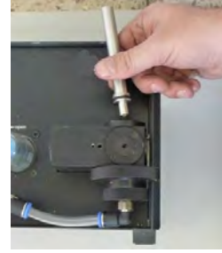
Abbildung 37: Herausnehmen des Aerosolführungsrohres
