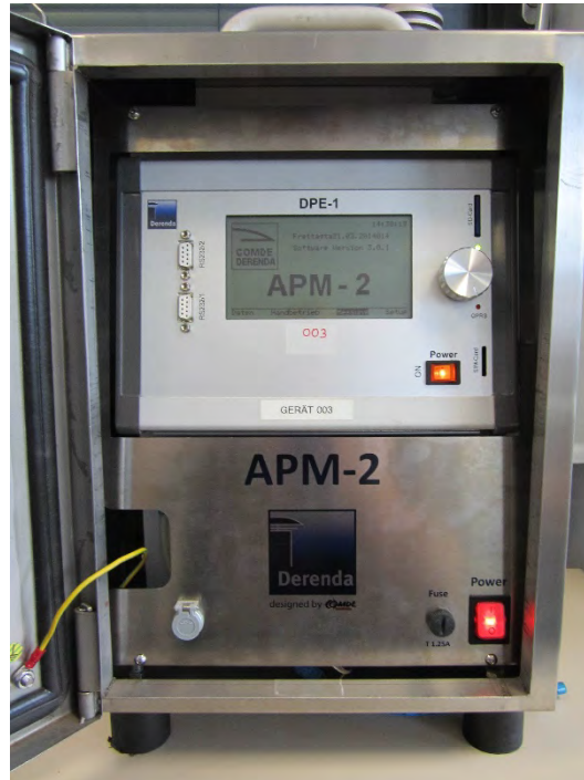
Abbildung 7: Ansicht APM-2 (Frontklappe offen)
