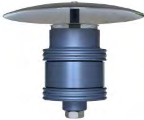
Abbildung 5: PM 10 -Probenahmekopf für APM-2
