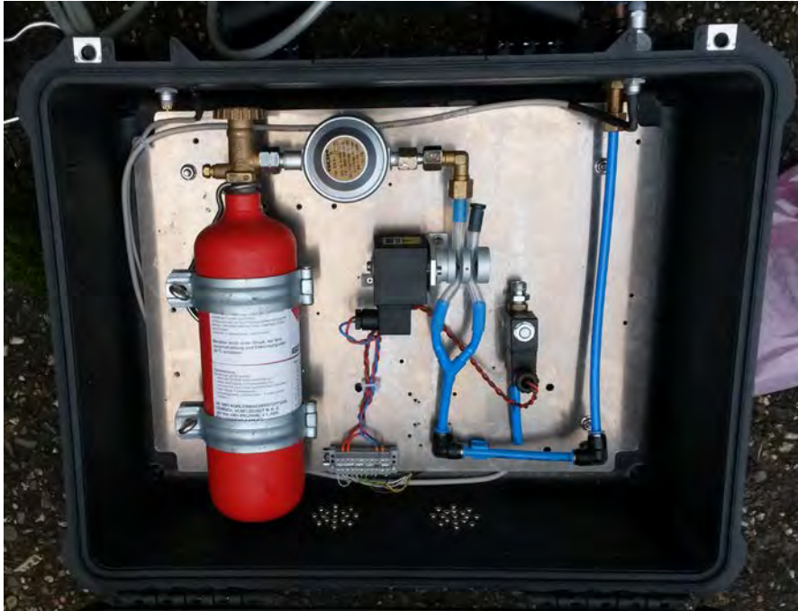
Abbildung 13: Prüfgaskoffer zur Überprüfung der Empfindlichkeit
