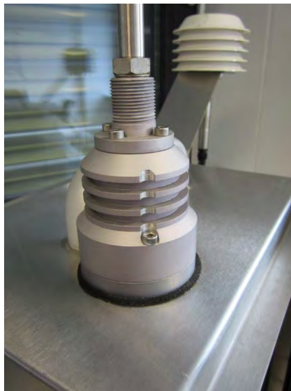
Abbildung 6: Virtual-Impaktor für APM-2
