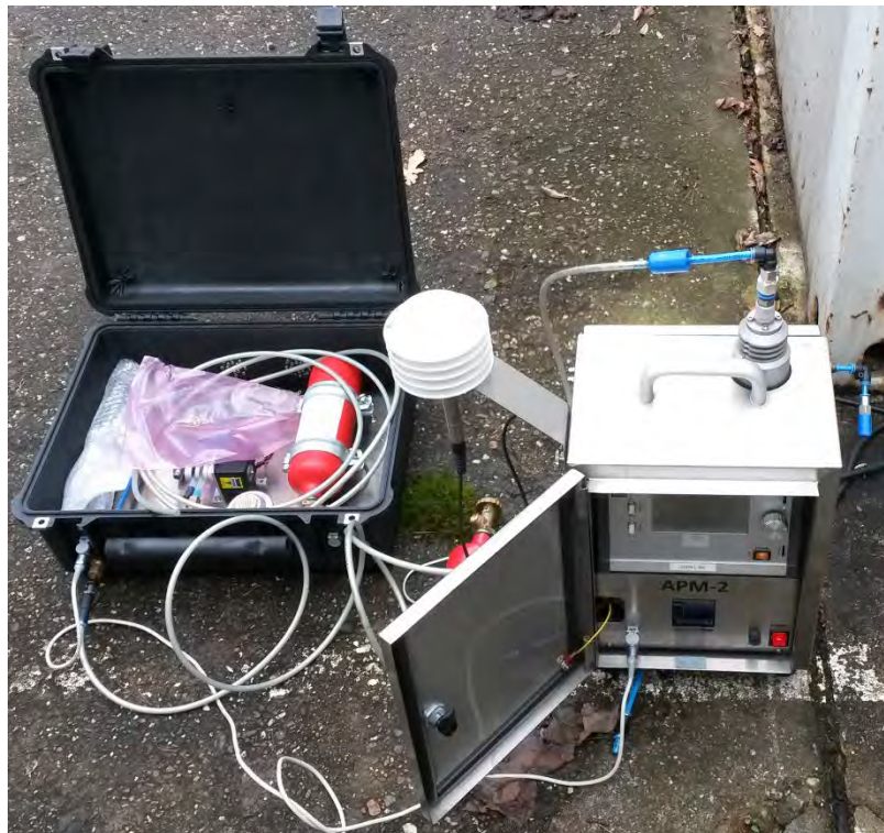
Abbildung 14: Prüfaufbau APM-2 + Prüfgaskoffer
