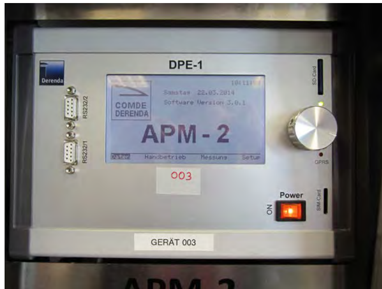
Abbildung 30: Ansicht Gerätevorderseite des APM-2 (rechts oben SD-Kartenslot, links RS232)
