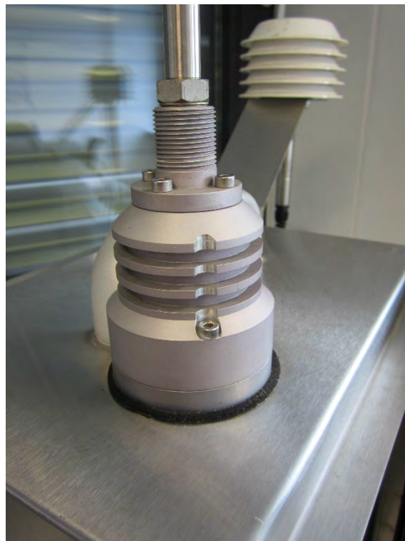
Abbildung 6: Virtual-Impaktor für APM-2
