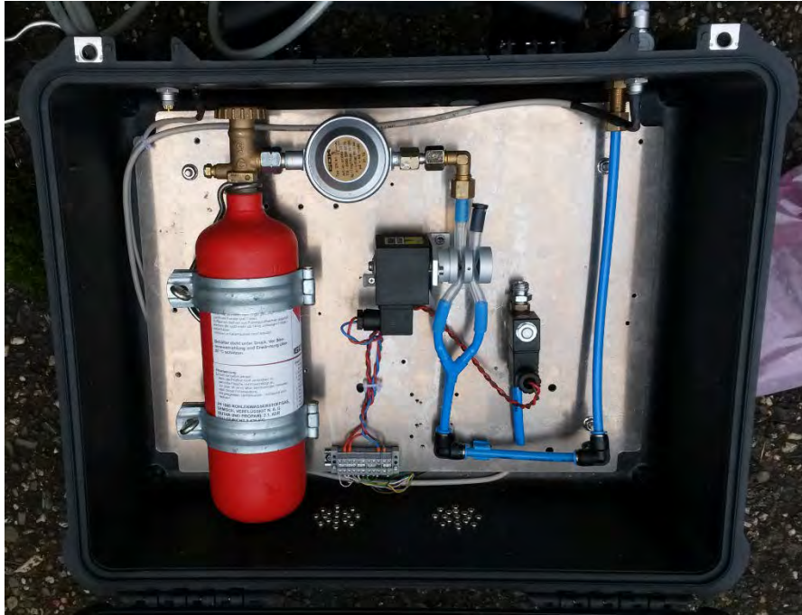
Abbildung 13: Prüfgaskoffer zur Überprüfung der Empfindlichkeit
