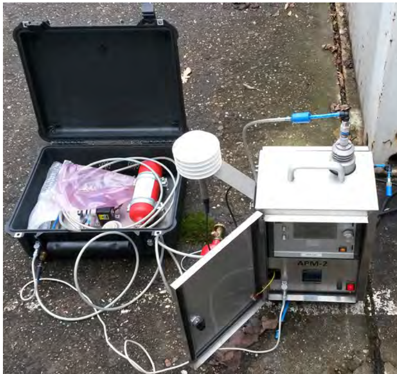
Abbildung 14: Prüfaufbau APM-2 + Prüfgaskoffer
