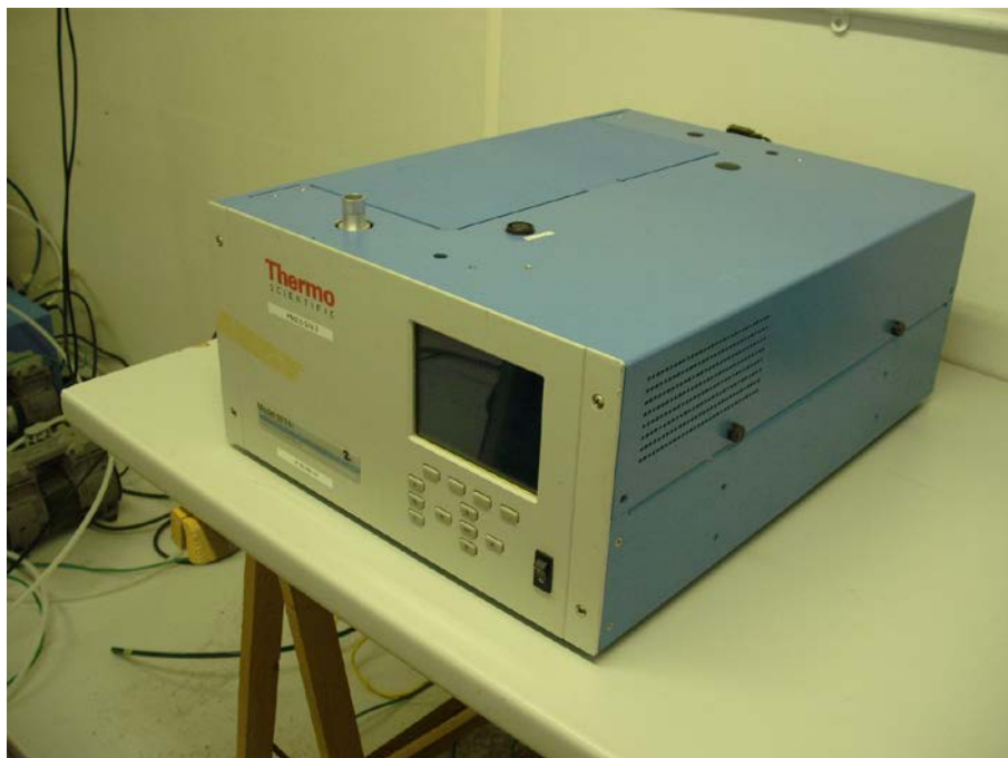
Abbildung 6: Messgerät Modell 5014i Beta – hier als Modell 5030i SHARP mit demontiertem Nephelometerbauteil
