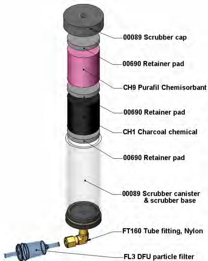
Abb. 9-4: Aufbau des Nullluftscrubbers
