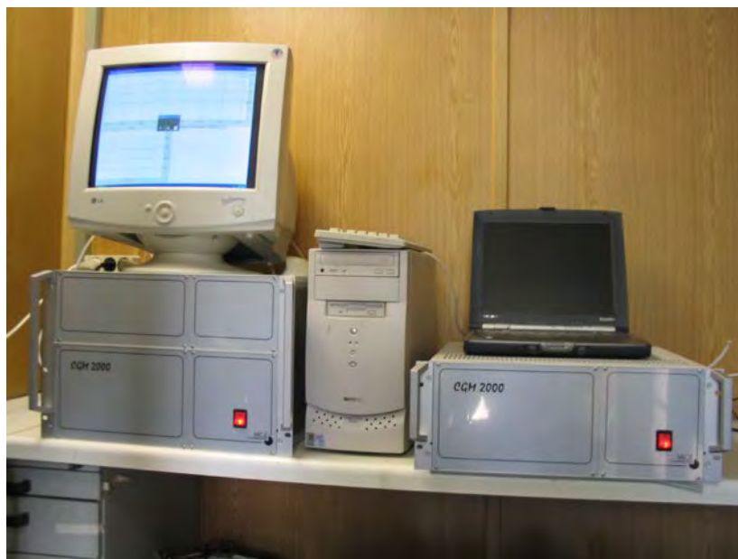
Abbildung 8: Aufbau des Permeationsofens und des Rechners zur Ansteuerung
