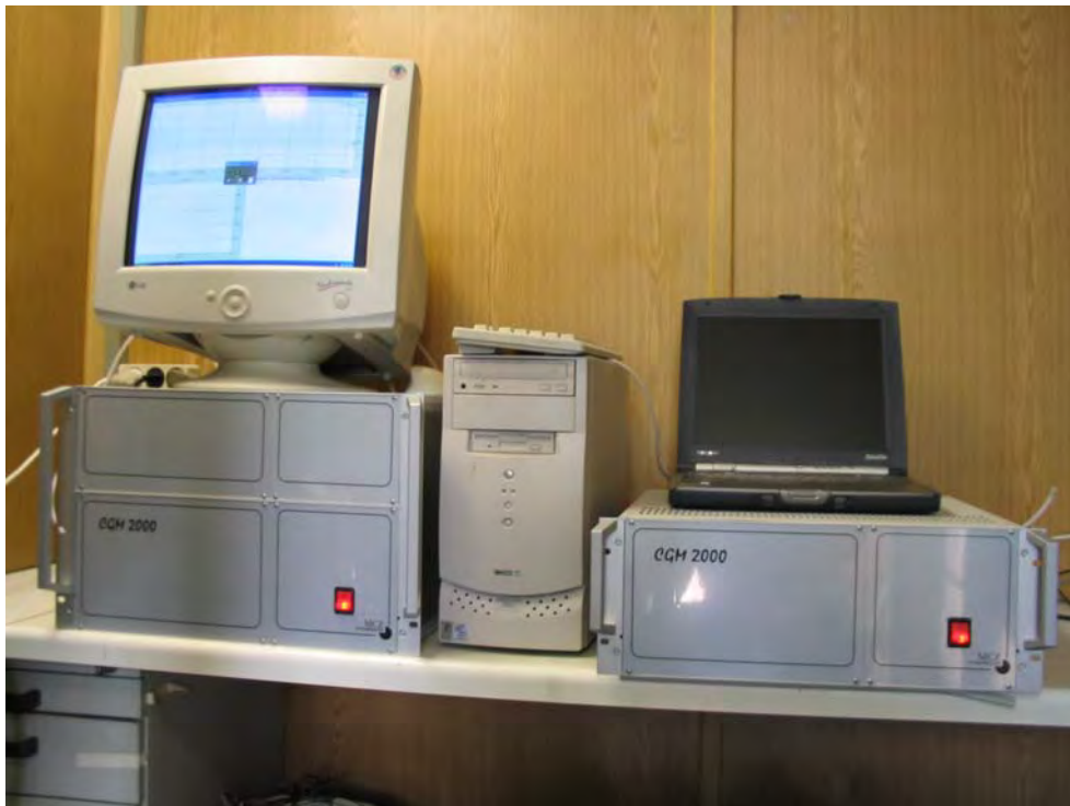
Abbildung 3: Aufbau des Permeationsofens und Rechner zur Ansteuerung
