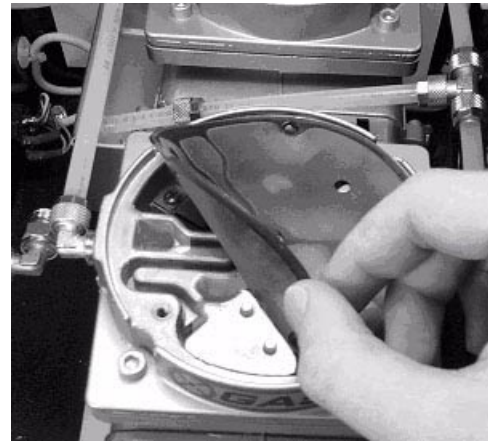
Figure 6.2. Wechsel der Pumpenmembranen, schritte 1 und 2.
