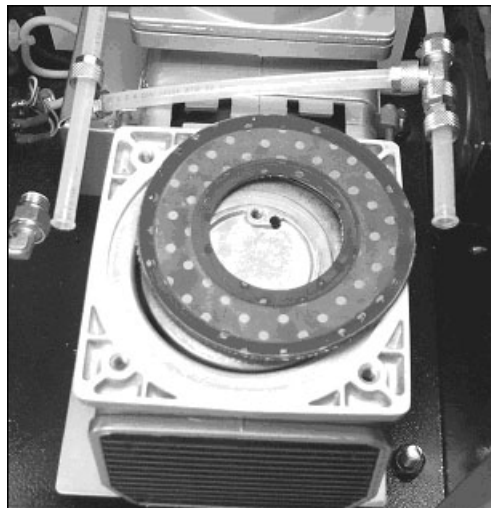
Abb. 6.5. Wechsel der Pumpenmembranen, schritte 6 und 7.
