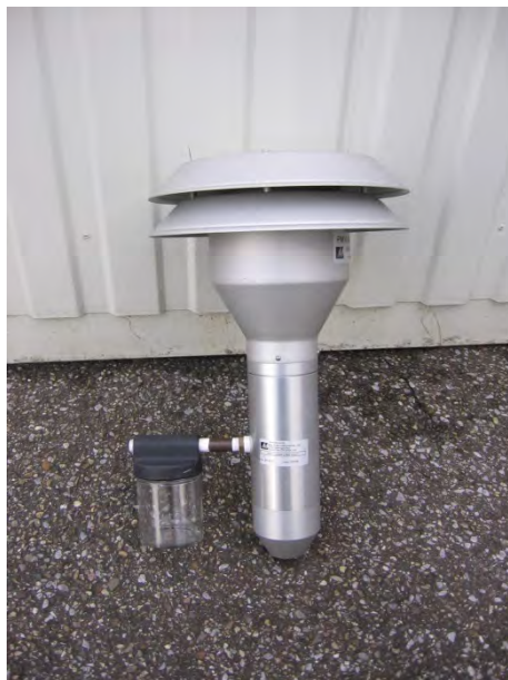
Abbildung 3: US-EPA PM 10 -Probenahmekopf BX-802 für BAM-1020
