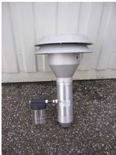
Abbildung 3: amerikanischer PM10-Probeneinlass BX-802 für BAM-1020
