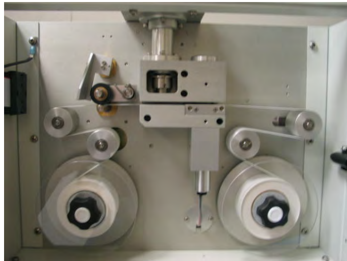
Abbildung 10: Vorderansicht BAM-1020, Frontklappe geöffnet
