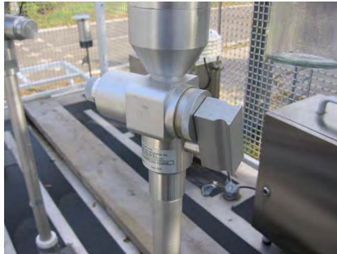
Abbildung 4: Sharp Cut Cyclone SCC BX-807 für BAM-1020
