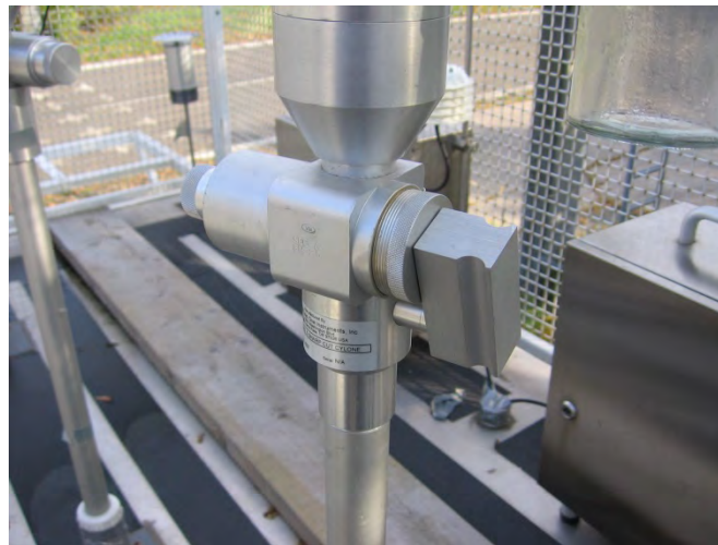
Abbildung 4: Sharp Cut Cyclone SCC BX-807 für BAM-1020
