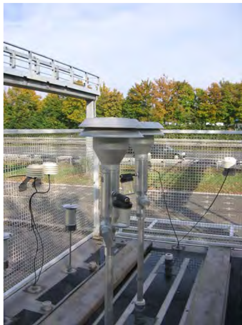
Abbildung 5: Probenahmekopf BX-802 + SCC BX-807
