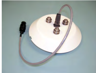
Verlängerung für Eiswasser-Kalibrierung
