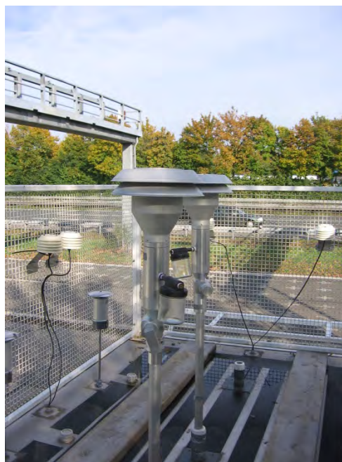
Abbildung 5: Probenahmekopf BX-802 + SCC BX-807
